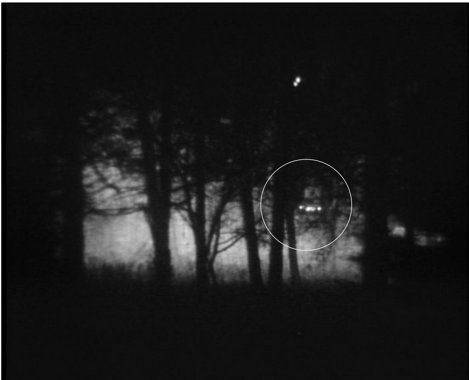
Рисунок 15. б) Режим с импульсной лазерной подсветкой на заданной дальности. Обнаружение автомобиля в лесу по блику выключенных фар.
