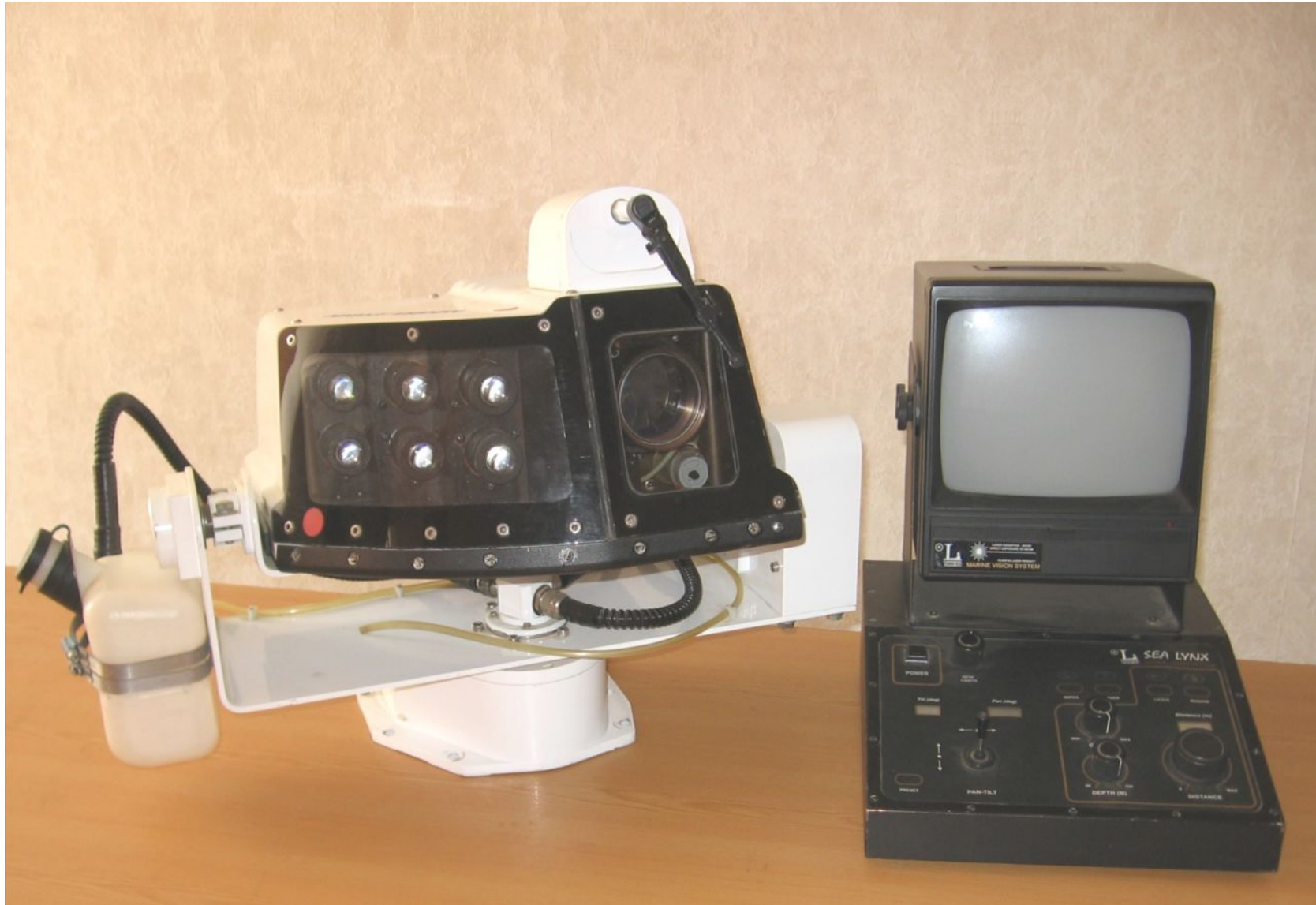
Рис. 14. – Индикатор с пультом управления и оптический блок ОЭСН
