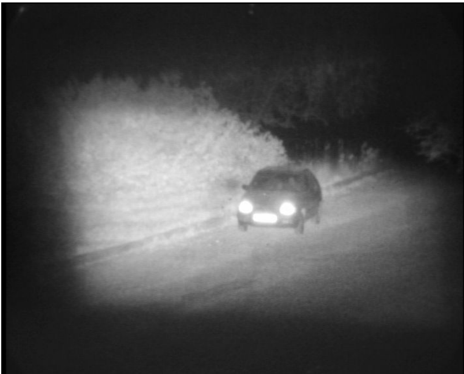
Рис. 17. б) Режим с импульсной лазерной подсветкой на заданной дальности. Включён дальний свет фар.
